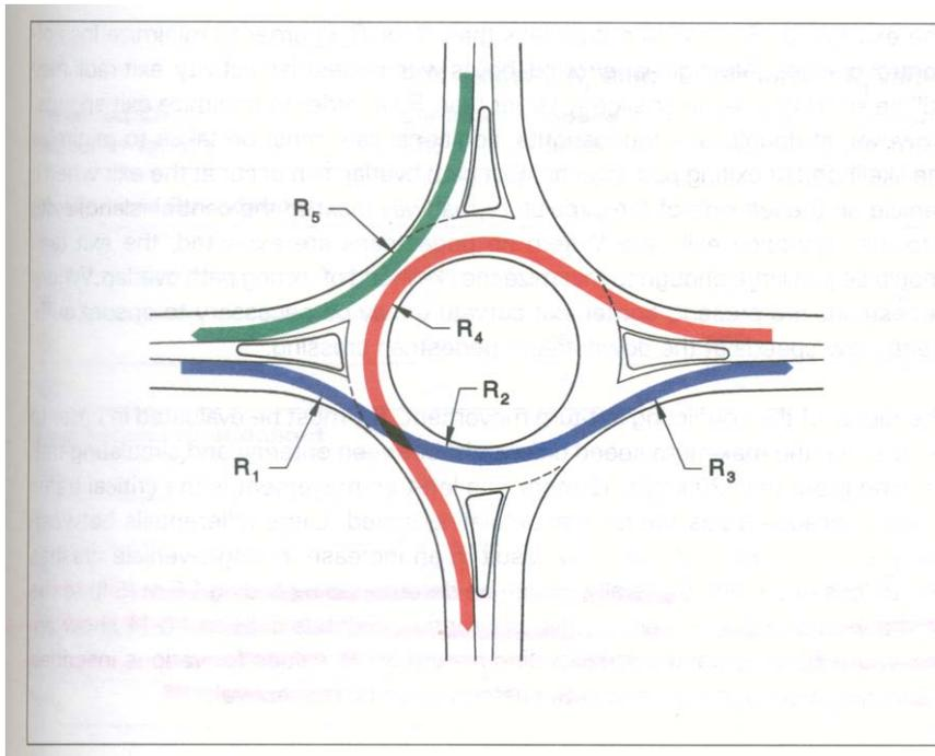
**FIGURE 1 ROUNDABOUT TURNING RADII IDENTIFICATION**
